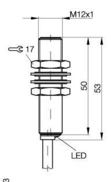
Induktiver Näherungsschalter BES M12MI-POC20B-BV03 M12x1 x 53 Öffner Sn=2mm bündig einbaubar
